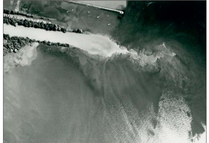
Abbildung 2: Durch die Kanalisierung der Zuflussmündung bis zur Halde wird die natürliche Deltabildung verhindert (Mündung der Aare in den Thunersee).
