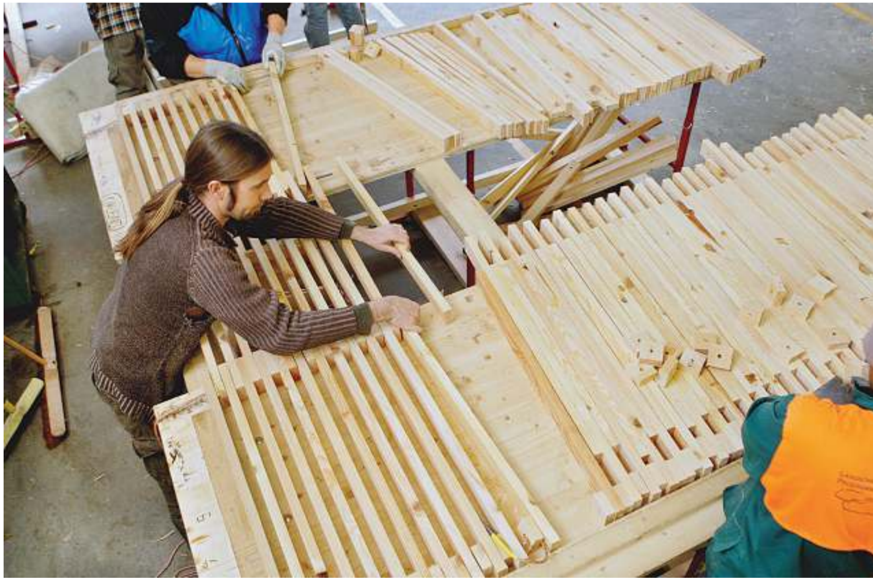
Die Produktion David Schöbi, Gruppenleiter vom Landschaftswerk Biel-Seeland, fädelt mit seinen Arbeitern zusammen die Latten auf den Rost. Am Eidgenössischen Turnfest werden diese Roste, die 2 Meter 40 im Quadrat messen, den Rasen auf den Parkplätzen schützen. Olivier Gresset
